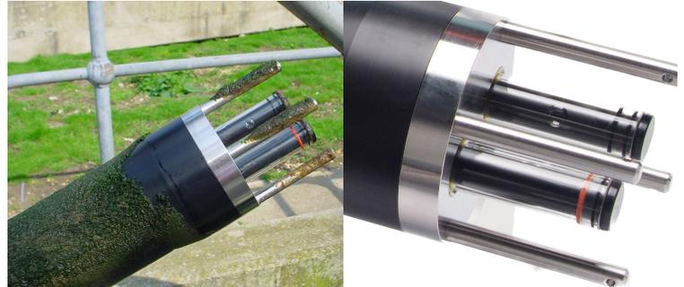
La sonde Turbi-Tech 2000LS est conçue pour contrôler le niveau des Matières En Suspension ou la Turbidité que l'on trouve typiquement en rejet final d'une station d'épuration municipale ou industrielle. Elle est également capable de surveiller les particules solides dans un process ou dans l'eau potable. La gamme de mesure standard est de 0 à 50 et 0 à 500 FTU qui peut être étendue pour certaines applications.
